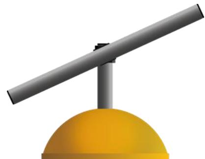
Abbildung 5: Gewinkeltes Magnelement (Konus + Winkelhalterung + Magnetstab (MCD))
