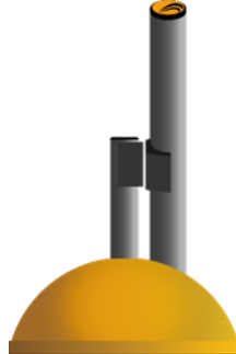
Abbildung 4: Gewinkeltes Magnelement (Konus + Winkelhalterung + Magnetstab (MCD))
