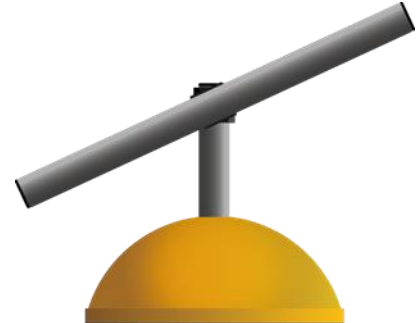
Abbildung 5: Gewinkeltes Magnelement (Konus + Winkelhalterung + Magnetstab (MCD))
